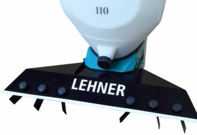
La tôle de guidage pour engrais verts permet la distribution précise des engrais verts entre le déchaumeur et le rouleau (suiveur). Le produit est directement projeté contre la tôle de guidage et exactement réparti par les ailettes d'éjection. Les engrais verts sont directement épanchés après leur passage par la tôle de guidage. Un autre avantage en est son insensibilité au vent, même en cas de traitement d'herbe. La tôle de guidage fait de nombreux adeptes.
