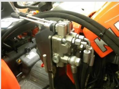
Distributeur pour le relevage et l'orientation (lame neige) ou le vidage du bac (balayeuse)
