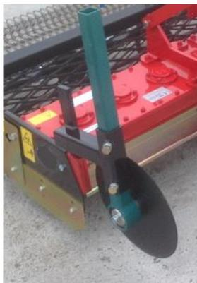
Le coupe bordure peut se monter indifféremment côté gauche ou côté droit de la herse. Une fois le support en place et bloqué, régler la profondeur de travail et immobiliser le disque à l'aide des 2 vis de blocage
