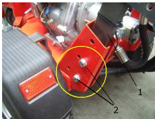
Photo 3 Réglage de l'inclinaison du guidon
