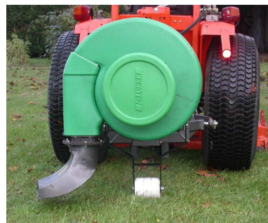
Photo 3 Sortie d'air verticale
