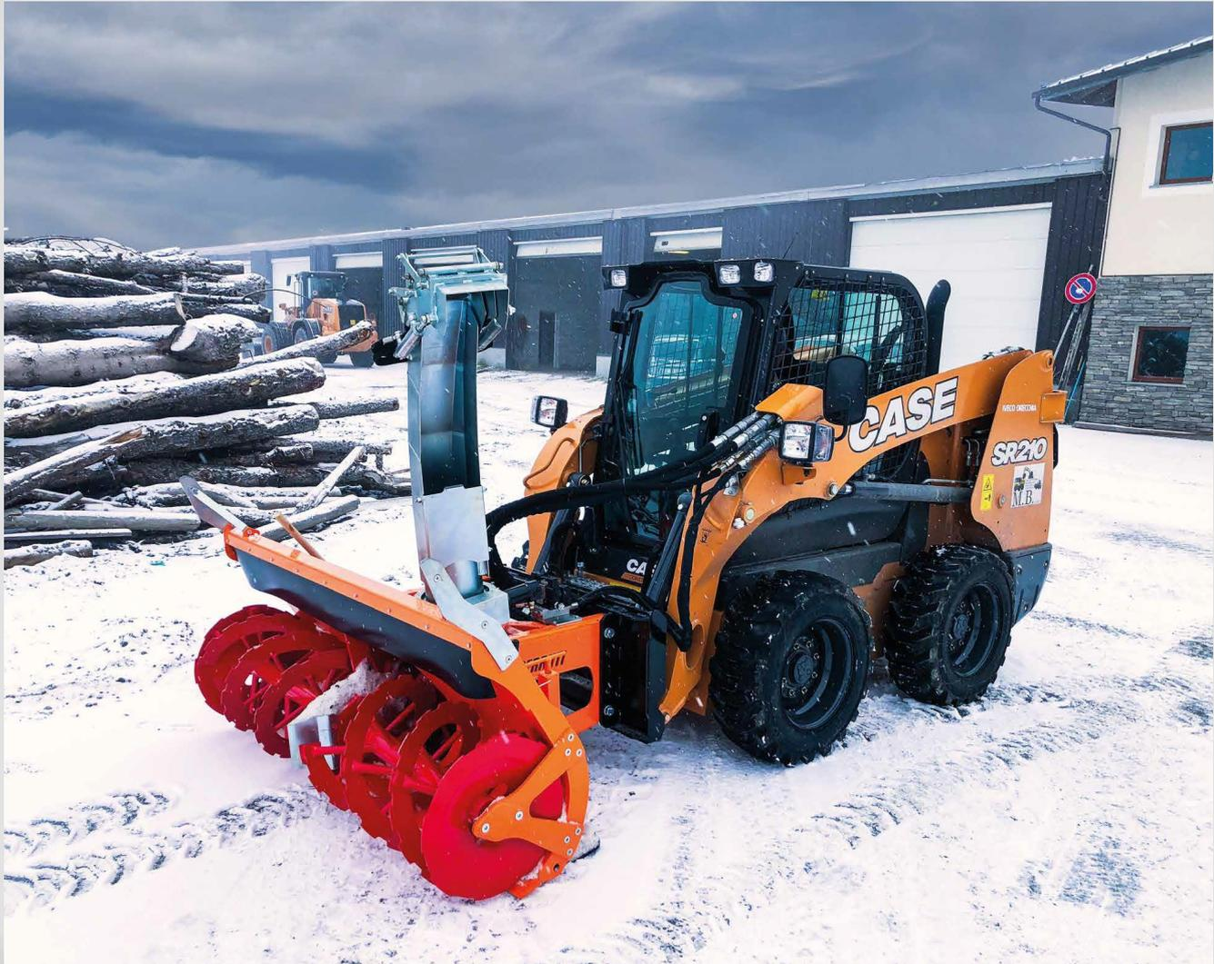
Fraise à neige à double étage à usage professionnelle, adaptée pour des tracteurs ayant une puissance et une capacité de levage limitées, entre 40 et 110 CV. Hauteur d'exploitation 850 mm, hélices frontales avec brise-glace Ø500 mm, ventilateur II étages Ø500 mm, équipée avec attelage à trois points, triangle, chargeur, rotation hydraulique de la goulotte d'éjection et réglage hydraulique du déflecteur. Il est possible de l'équiper avec une large gamme d'accessoires.
