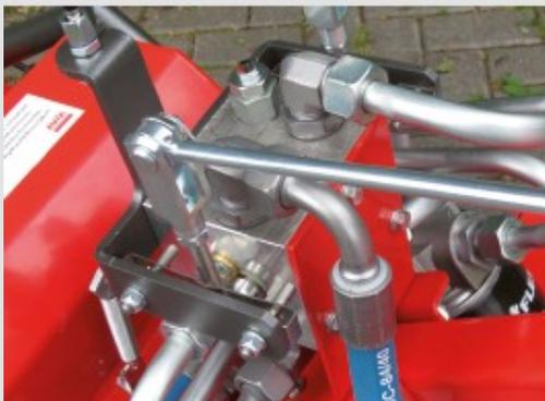
Fonctions hydrauliques, avancement et fraise
