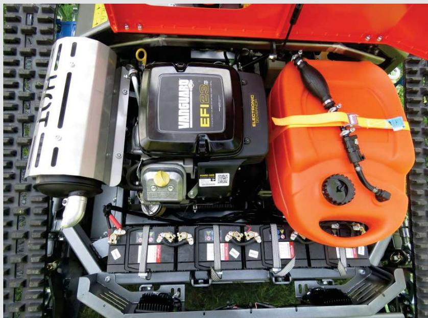
Moteur Vanguard bi-cylindre de 23 CV à injection électronique EFI
