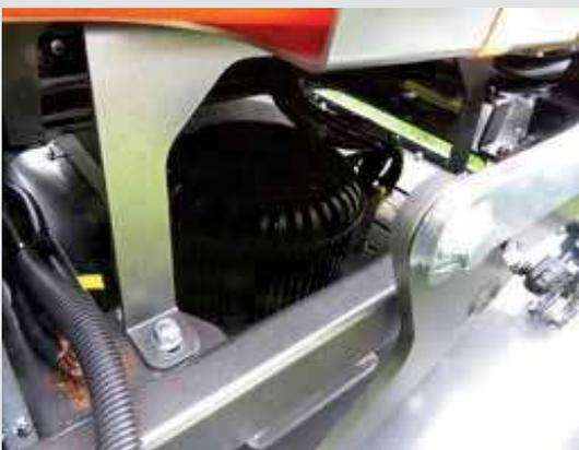
Entraînement électrique du plateau de tonte avec gestion électronique de la charge
