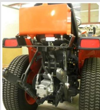
Pompe hydraulique et réservoir d'huile
