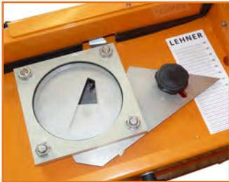
Le clapet de dosage permet de régler progressivement la quantité à épandre.
