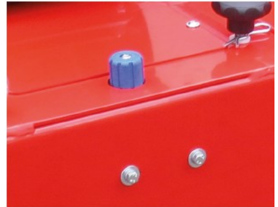
Réglage en continu de la vitesse du rouleau enfouisseur
