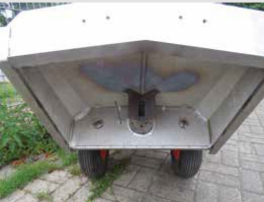
chambre de combustion
