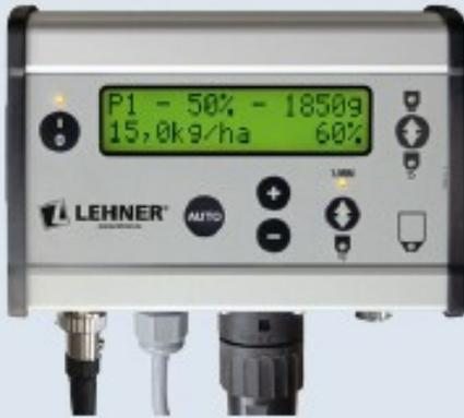
L'AUTO-DOSAGE ajuste automatiquement la position de la vanne en fonction de la vitesse de conduite. Après avoir sélectionné le matériau et entré la largeur d'épandage et le débit à l'hectare souhaités, AUTO-DOSIS réagit automatiquement aux manœuvres de freinage et d'accélération et commande la vanne de dosage en conséquence. Cela permet de maintenir constant le taux d'épandage souhaité.
