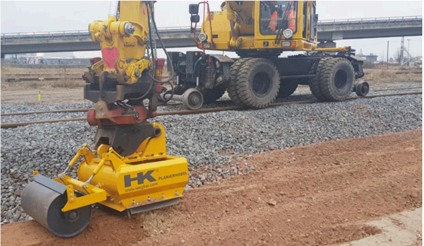
Avec le HK SmartGrader, les travaux de nivellement et de terrassement peuvent être effectués rapidement et facilement sans perte de matériau latéral. De plus, le HK SmartGrader avec sa lame de répartition et sa barre de ripper peut également être utilisé pour la construction de routes. Avec le rouleau de compactage traîné, le matériau est compacté de manière statique et pressé sur les travaux de terrassement.
