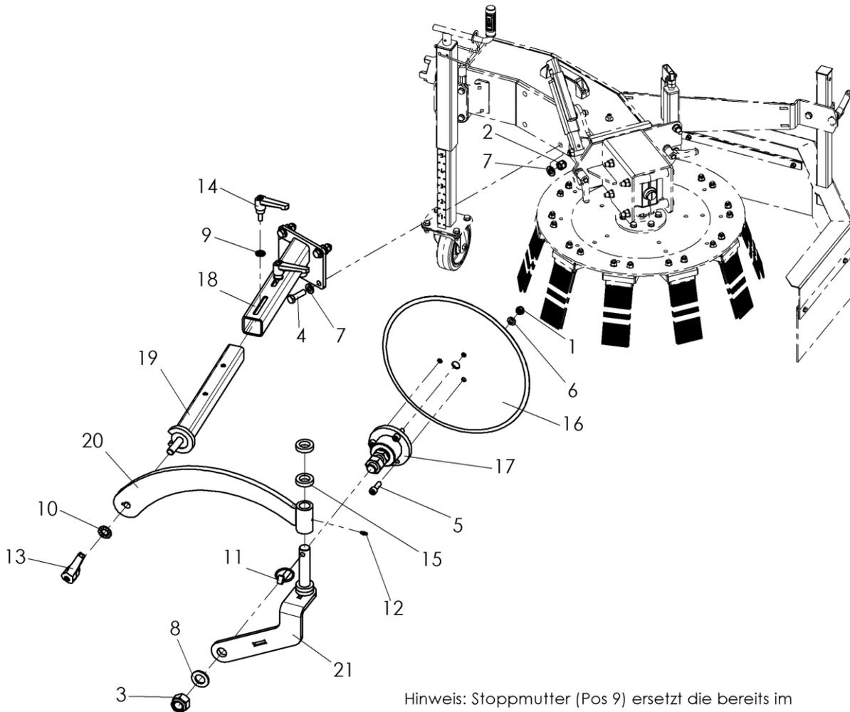
Hinweis: Stoppmutter (Pos 9) ersetzt die bereits im Lieferumfang von 950 400 085 (Pos 6) enthaltene Mutter
