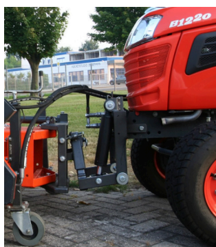
Dispositif de levage et d'orientation hydraulique par vérins
