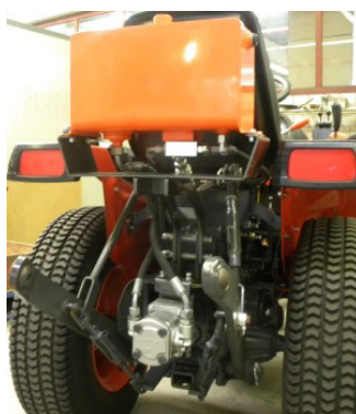
Réservoir d'huile placé derrière le siège de la tondeuse et pompe hydraulique entraînée par la prise de force
