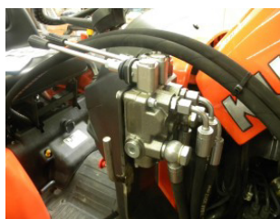
Commandes par distributeur à 2 leviers pour l'orientation G/D et le relevage
