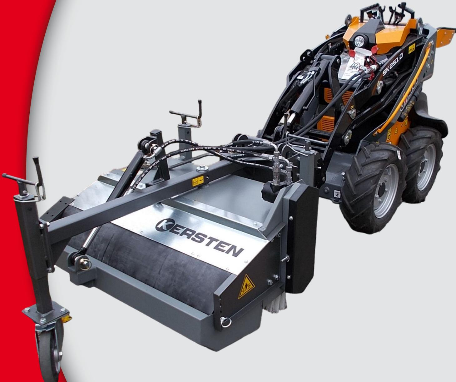
Montage sur chargeurs compacts type Toro Dingo, Avant, Giant SK, Merlo M12.3, Vermeer 650 TX, CAT
