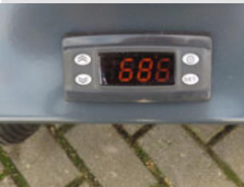
Affichage de la température de la chambre de combustion
