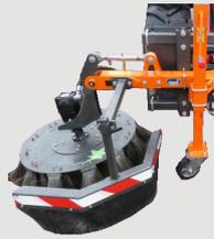
Brosse de désherbage, entraînement hydraulique 30 L/ mn 175 bar pour tracteur de 30 à 90 CV . Travail possible à gauche et à droite. Poids 165 kg
