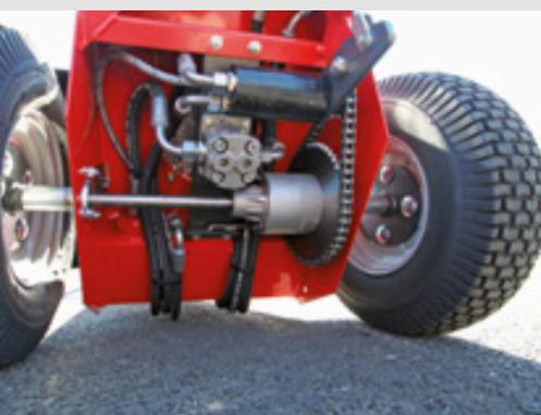
Avancement hydrostatique avec pont et différentiel
