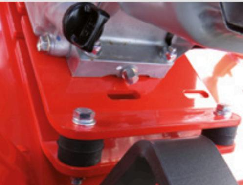
Moteur à vibrations amorties pour un travail sans fatigue. Vibrations main-bras inférieures à 2,5 m/s<sup>2</sup>
