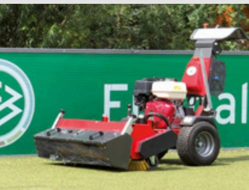
Balayeuse frontale pour gazon artificiel avec moteur hydraulique puissant
