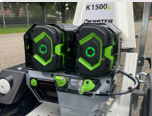
Deux compartiments à batteries sur le moteur, les batteries peuvent être facilement remplacées
