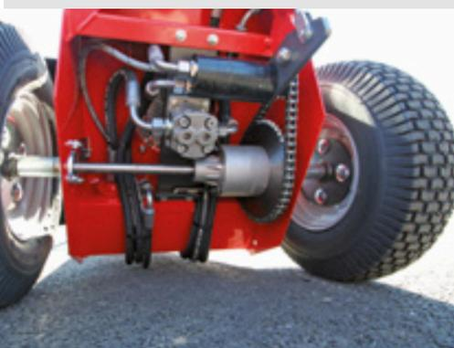
Avancement hydrostatique avec pont et différentiel
