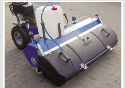
Rampe de pulvérisation sur K1500 G-E
