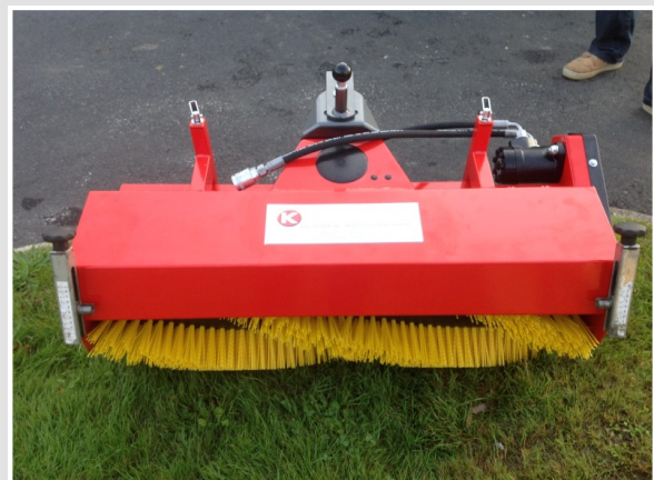
Balai de 100 cm, avec moteur hydraulique renforcé
