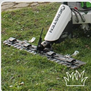
Le lamier à double lame permet de faucher en ménageant les insectes et la surface. Le concept de double lame est unique en son genre, il garantit une vitesse de fauche élevée tout en assurant un rendement de fauche élevé. Les lames de coupe ESM Carbodux® brevetées garantissent une longue durée de vie.
