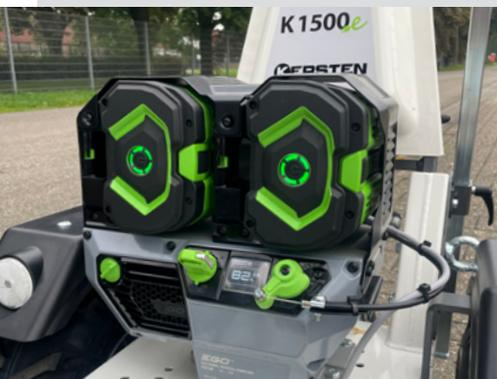
Équipé d'un moteur EGO, deux compartiments à piles sur le moteur, les batteries peuvent être facilement remplacées.
