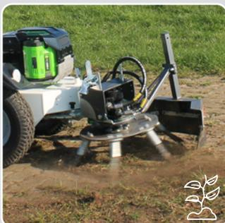
La brosse mécanique pour herbes sauvages permet d'éliminer rapidement et sans effort les herbes sauvages gênantes. Même les mauvaises herbes les plus tenaces sont éliminées en profondeur jusqu'à la racine. Le plateau de la brosse, d'un diamètre de 50 cm, peut être équipé de différents outils. Le HOAF thermHIT permet l'élimination thermique des mauvaises herbes.
