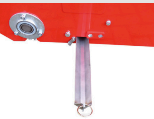
▼ Gouttière pour le réglage de la quantité de semences
