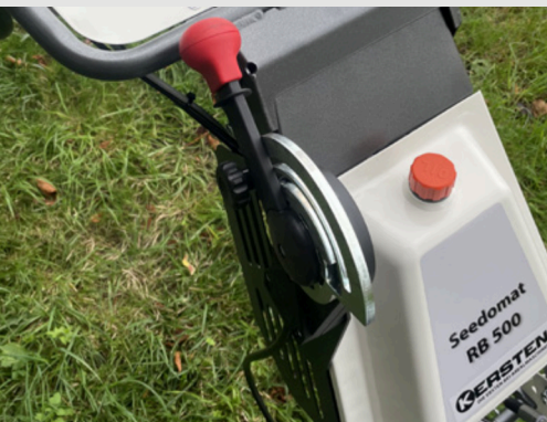
▼ Réglage de la hauteur de la console et réglage du débit
