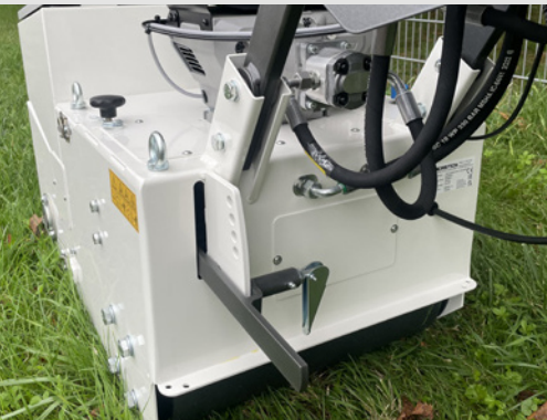
▼ Réglage de la profondeur de travail du rouleau hérisson
