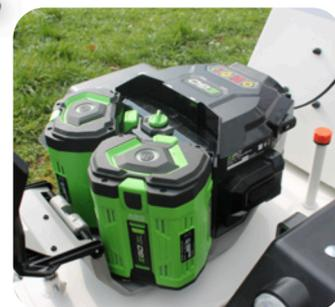
Deux compartiments à batteries sur le moteur, les batteries pouvant être facilement remplacées.
