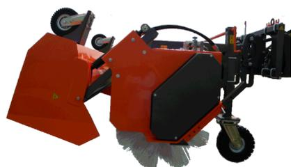
Le bac de grande capacité s'ouvre largement pour permettre un vidage aisé. De série il dispose de 2 roues frontales. Le bac est flottant ( système breveté ) ce qui signifie que lorsqu'il aborde une dénivellation, il coulisse verticalement permettant ainsi au balai de rester en contact avec le sol.
