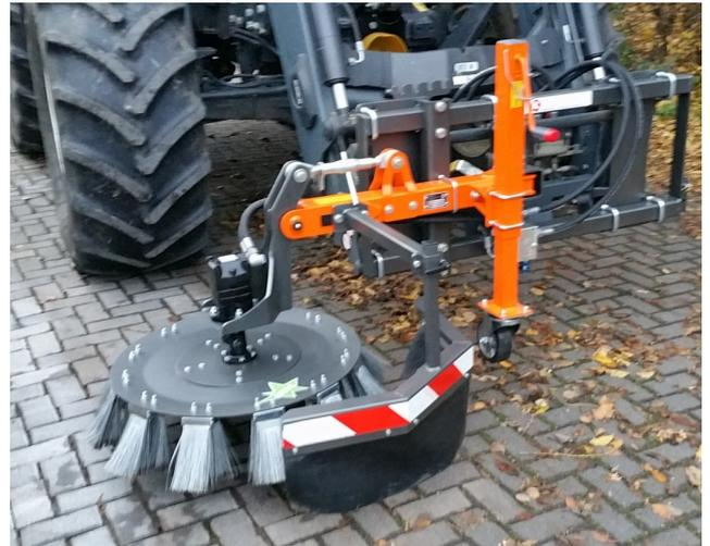
**UB EASY PAK FL** Version de base avec réglage mécanique de l'angle de brosse (hydraulique avec option S1037)
