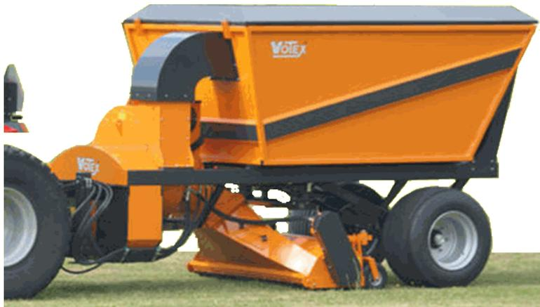
De série la VT420 dispose d'une trémie d'aspiration de 1,7 mètre de large capable de suivre le relief du sol et équipée d'un balai entraîné hydrauliquement (mécaniquement en option). En option, le balai peut être facilement remplacé par un rotor scarificateur ou un rotor de tondeuse à fléaux, ce travail étant facilité grâce à un chariot permettant une mise en place et un retrait aisé. Dans les 2 cas, l'herbe et les feuilles sont collectées en un seul passage.
