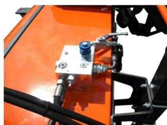
Bloc hydraulique et vanne d'arrêt
