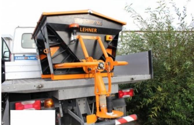
Polaro XL avec châssis en polyéthylène moulé par injection
