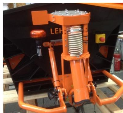
Distributeur repliable pour le stockage
