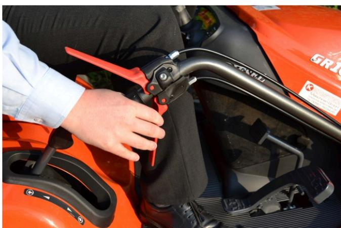
Poignée inférieure pour le relevage et la descente de la lame
