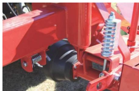
Système de tension des courroies
