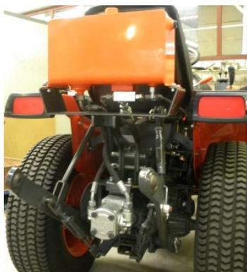
Pompe hydraulique et réservoir pour B1220
