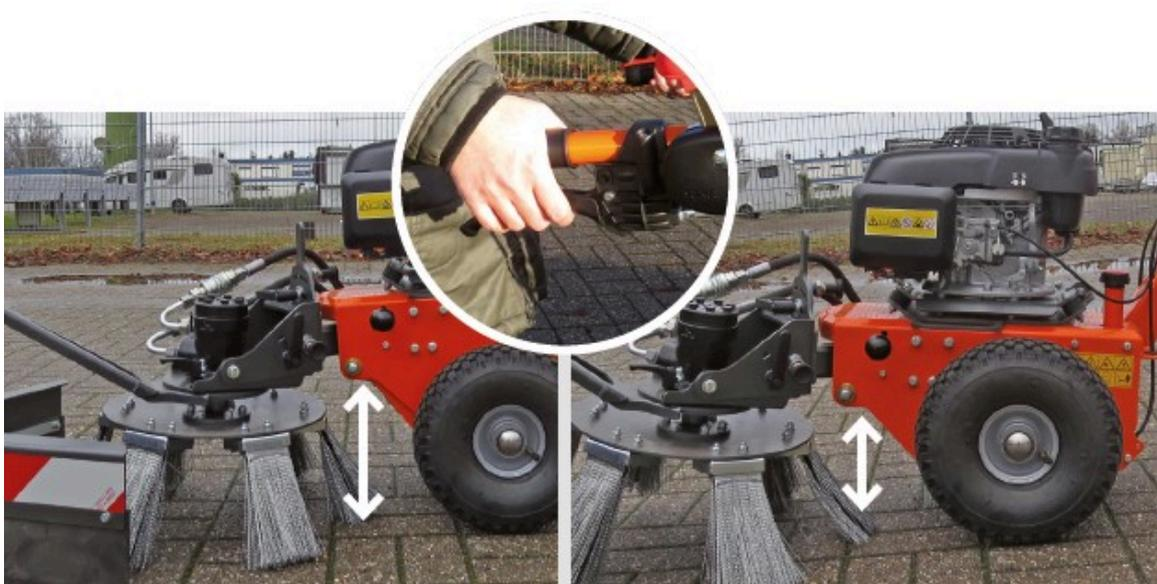
Axe réglable en hauteur en continu (6 positions) pour compenser l'usure des brosses sans avoir à modifier le réglage.
