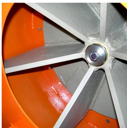
Turbine en Hardox de 16 mm
