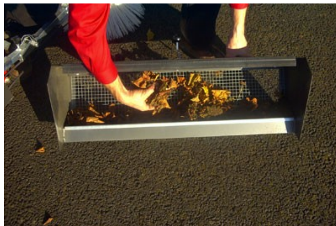
Bac métallique avec grille de séparation
