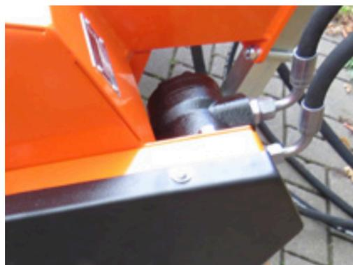
Moteur hydraulique positionné de façon à être protégé
