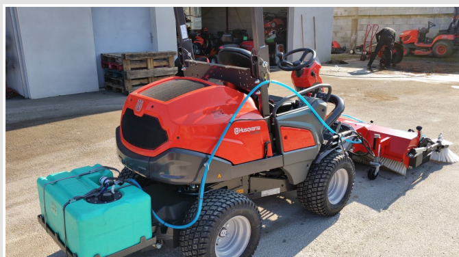
Rampe de pulvérisation avec cuve 50L
