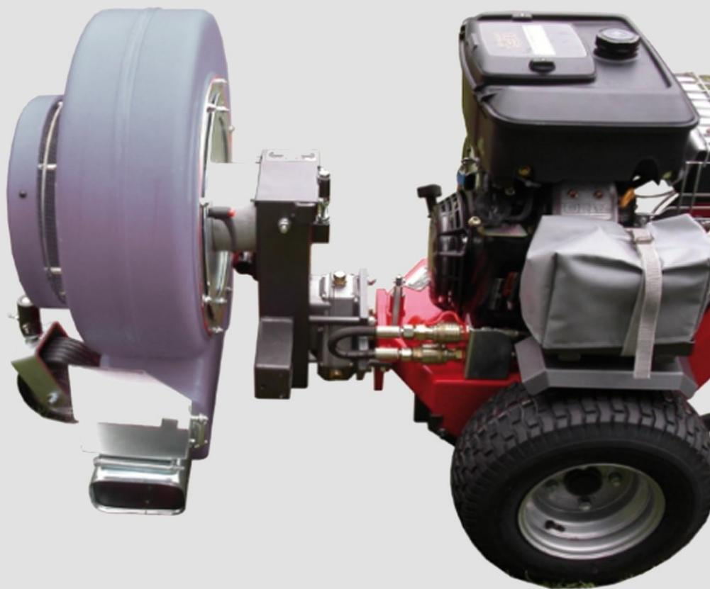
Souffleurs équipés d'un système de réduction de bruit à l'aspiration et à la sortie d'air. Enveloppe de turbine en polyéthylène.
