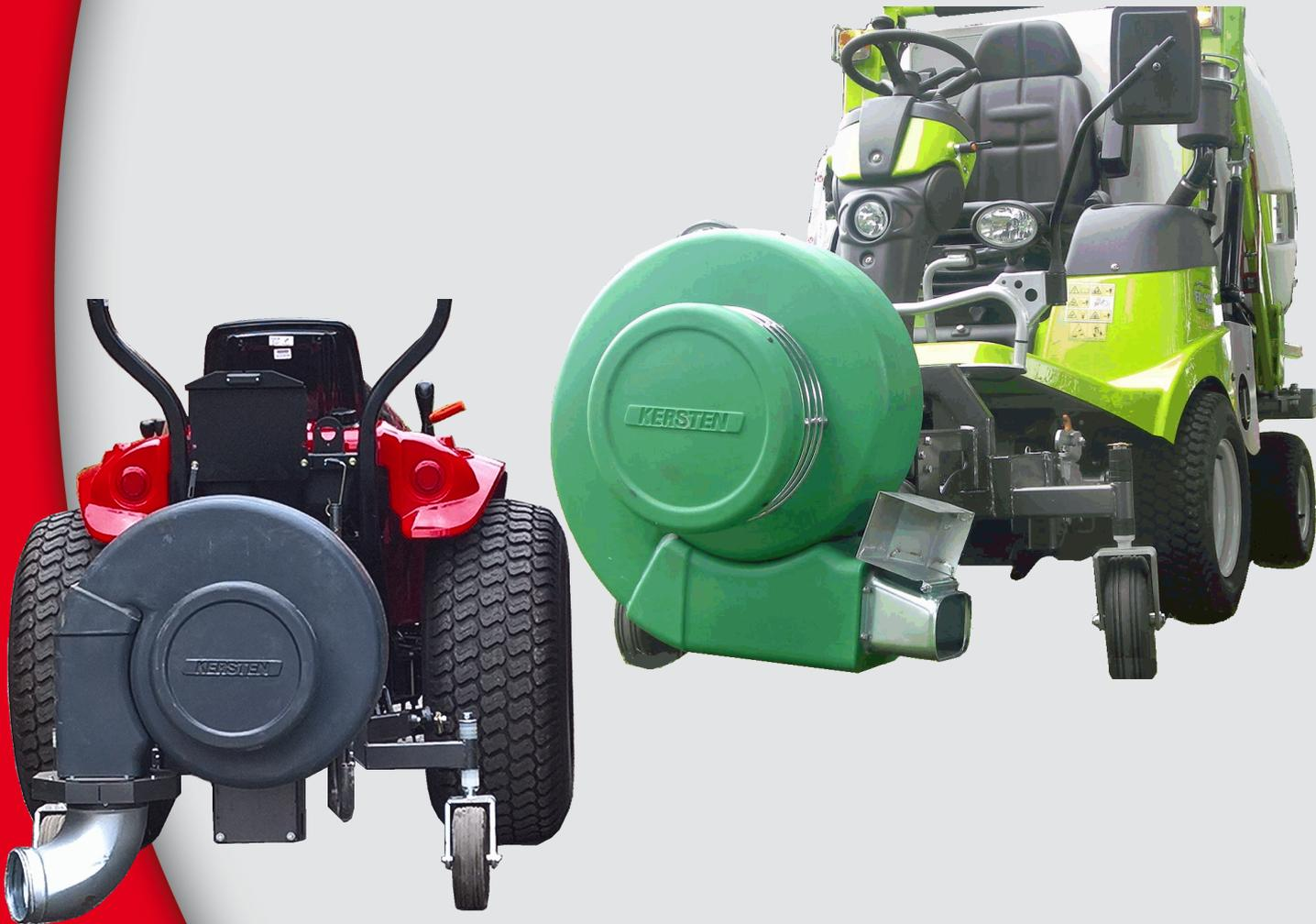
Souffleurs équipés d'un système de réduction de bruit à l'aspiration et à la sortie d'air. Enveloppe de turbine en polyéthylène.
