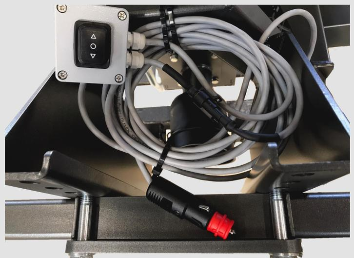
Boitier de commande du vérin électrique 12V
