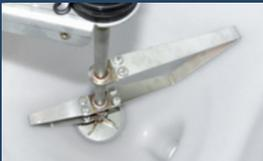
Agitateur salin avec entraînement 12 V pour matériaux à faible écoulement. Si la machine est utilisée pour le sablage, le support supérieur peut être retiré pour soulager le moteur.
