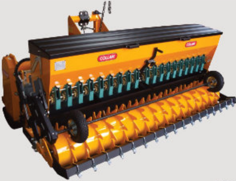
ACLIS avec semoir FAG-MELO et rouleau packer
