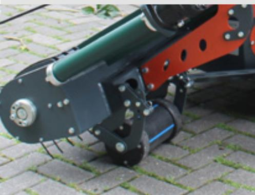
Réglage simple de la hauteur des roues
