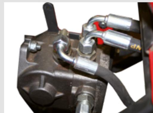
Pompe axiale à pistons, haute pression
