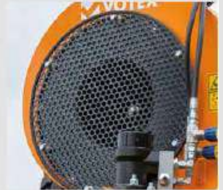
Entrée d'air protégée
