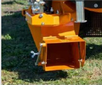
Réglage vertical mécanique du volet d'air (hydraulique / électrique en option)
