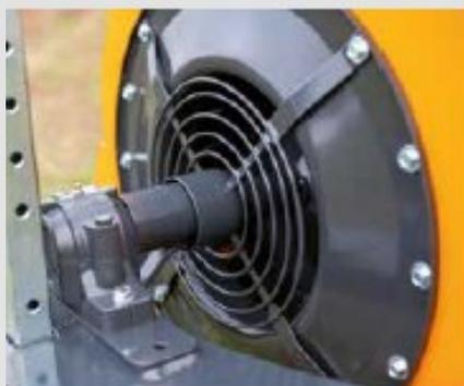
Volume d'air important grâce à une turbine puissance et une double entrée d'air
